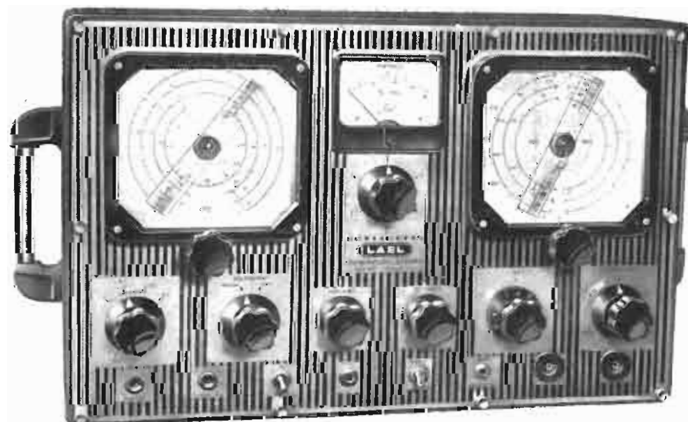
Attenuatore calibrato a impedenza d'uscita costante 75 Ω - Precisione taratura A. F. 1 % - B. F. 3 % - gamma M. F. 0,1 % - Voltmetro indicatore portante R. F. e % modulazione - Valvole usate 955 - EL41 - EAF42 - AZ2 - VR150 - Alimentazione CA per tensioni di rete da 110 a 220 V - Dimensioni 550×330×240 m/m - Peso Kg. 22 circa.
